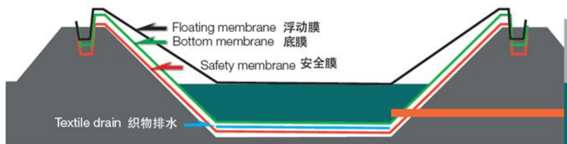
厌氧黑膜沼气池存储示意图
