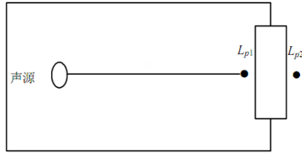
图 4-1 室内声源等效为室外声源图例
